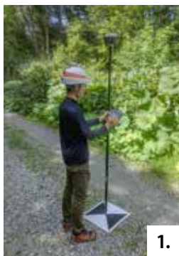
ICT技術による測量の様子。 1. RTK-GNSS 2. LiDAR
