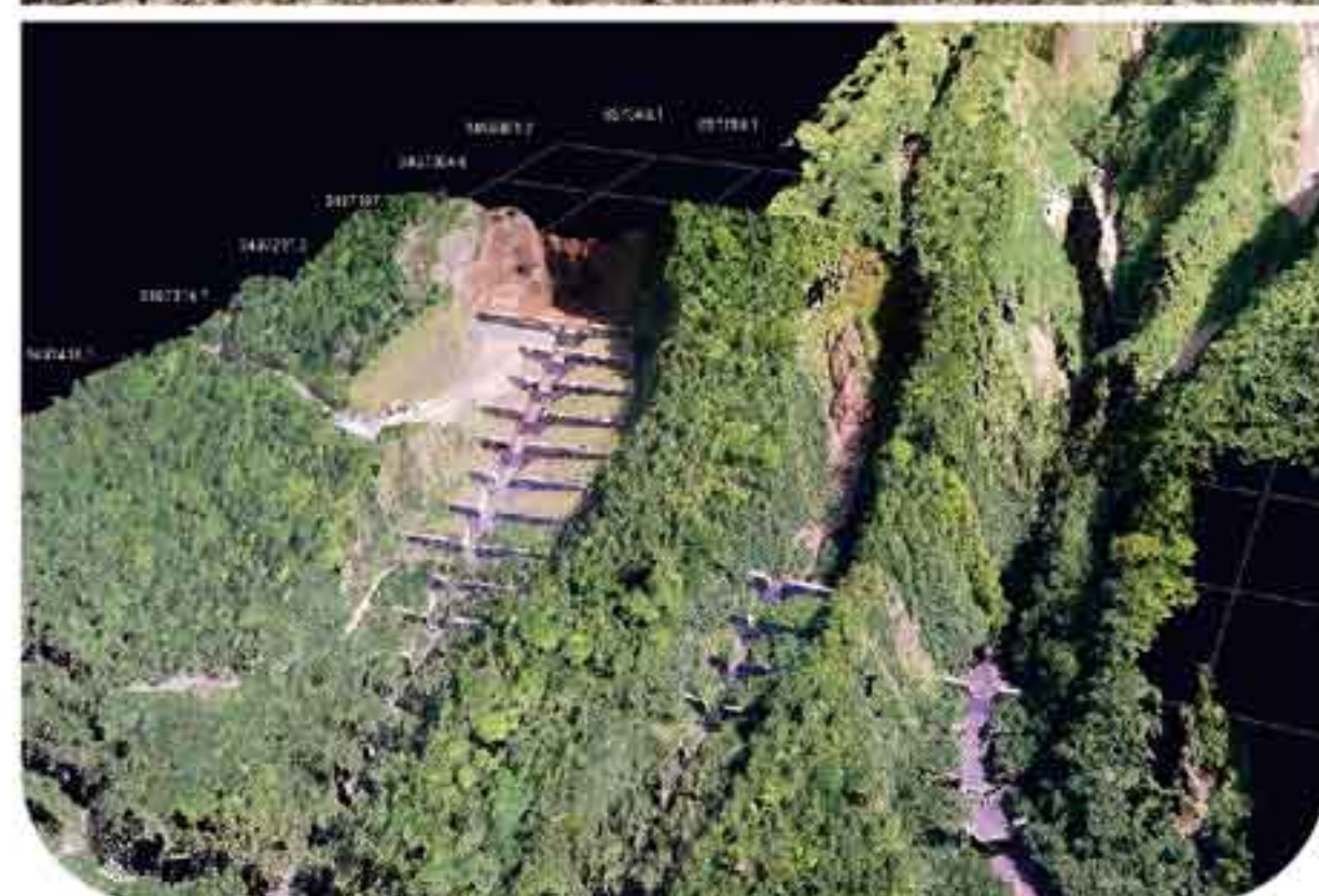
▲ 崩壊源頭の様子 ▼ 3D点群処理システムを用いた解析 ◀ 当社作成の平面図
