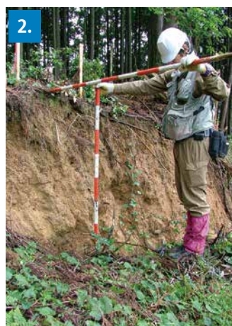
トップ写真：令和元年 7 月 復旧状況（林道高木線起点付近） 1. 土壌硬度測定風景。2. クラック（亀裂）測定風景。
